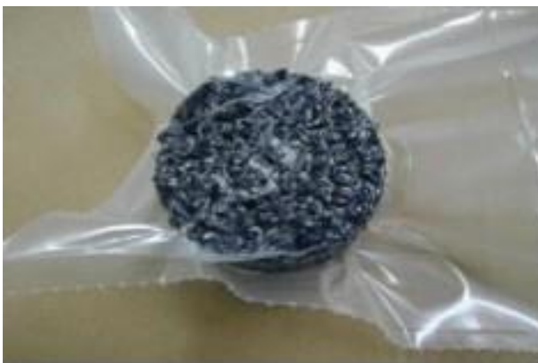
Fotografia 2. Sposób uszczelnienia próbki w metodzie CoreLok
